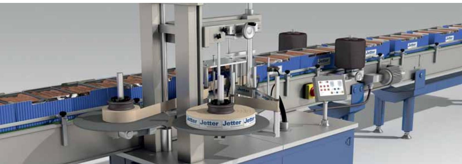
Runde Behälterformen und Sonderformen bedeuten eine hohe Herausforderung für die Automatisierung von Etikettiermaschinen. Hierbei werden häufig umlaufende und an Design und Größe angepasste Etiketten aufgebracht, was einen speziellen Aufbau der Maschinen erfordert.
