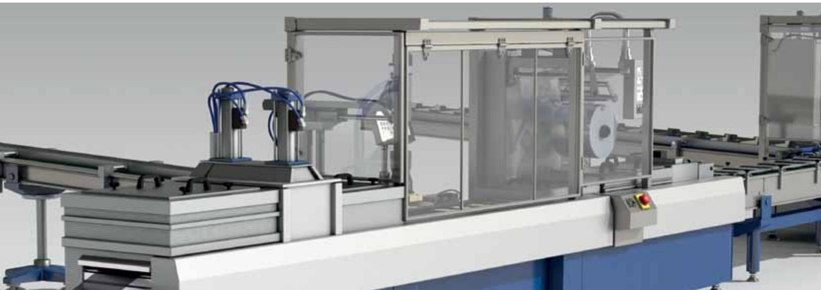
In einer Linie lassen sich Schalenerstellung, Produktzuführung, Schutzbegasung (MAP) und Versiegeln integrieren. Thermoformmaschinen sind somit vorwiegend in der Lebensmittelindustrie zum Verpacken von Frischware im Einsatz.
