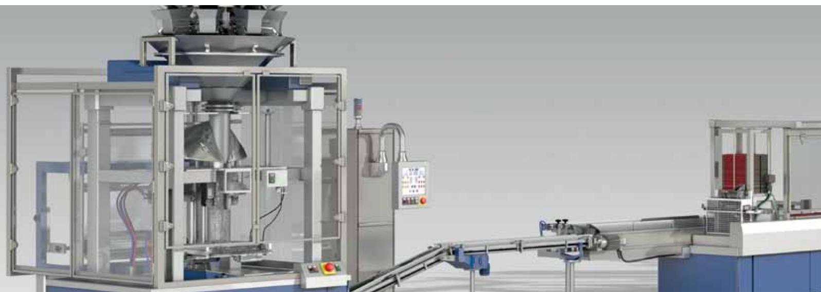
Vertikale Schlauchbeutelmaschinen eignen sich zur Beutelverpackung für alle pulverförmigen frei fließenden Produkte sowie für Flüssigkeiten. Dafür kommen äußerst flexible Automatisierungssysteme - klassische SPS-Lösungen sowie rechenintensive Mehrachs Anwendungen (Motion Control) - zum Einsatz.
