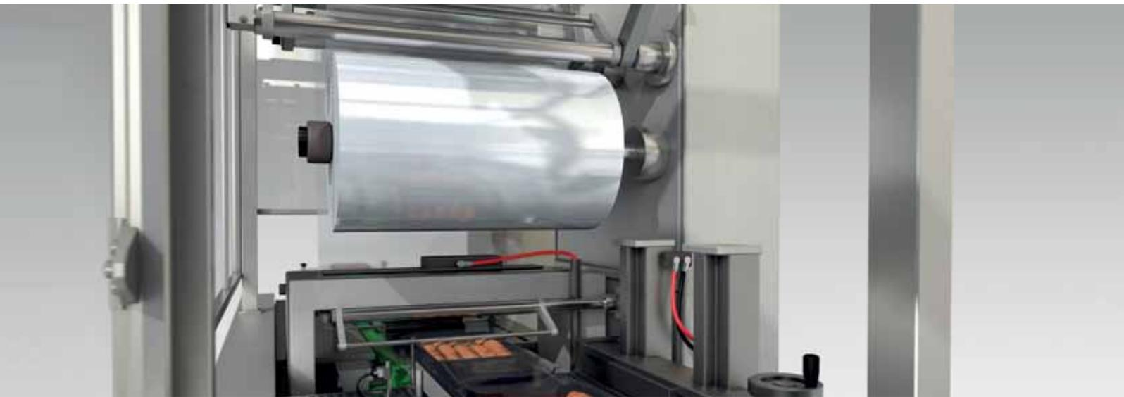
Horizontale Schlauchbeutelmaschinen eignen sich für alle formstabilen Produkte, die über eine Mitnehmerkette oder ein Flachband lagegerecht eingetaktet werden können. Für die Folie ist die exakte Folienspannung ein wichtiger Aspekt. Der Folienvorschub erfolgt über die kombinierten Einzugs- und Längssiegelrollen, die auch die Länge der einzelnen Verpackungen variabel regeln.
