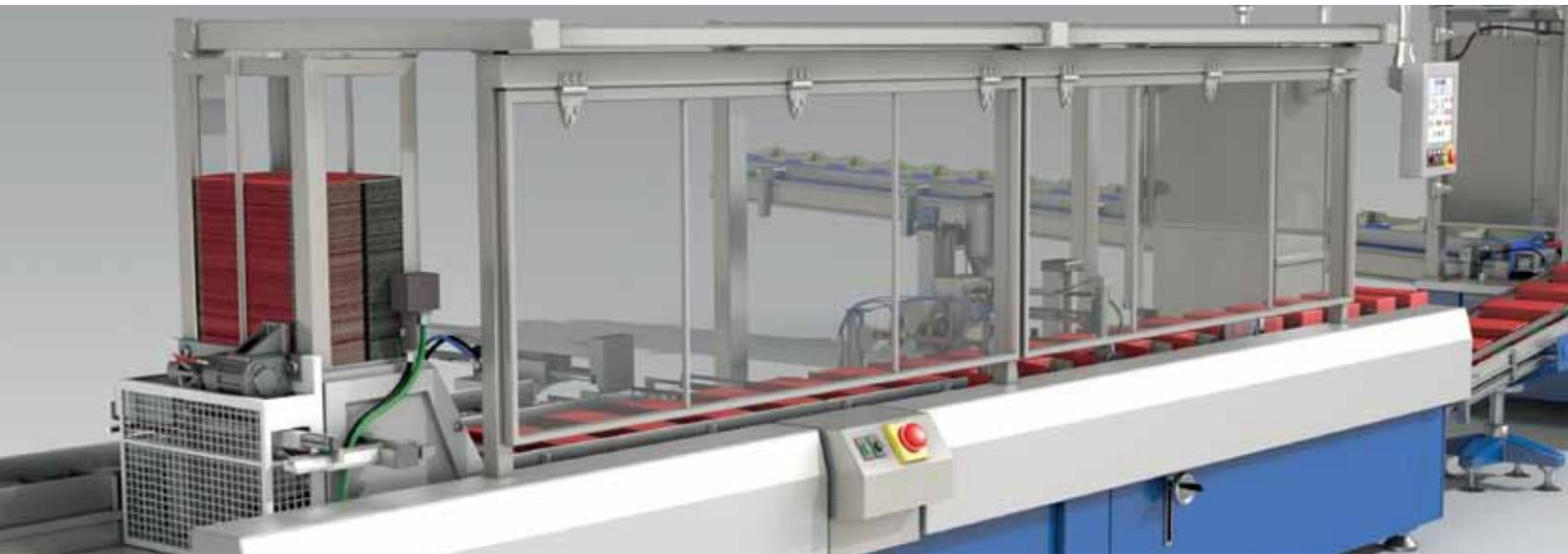
Kartonierer oder Kartoniermaschinen verpacken das Packgut in vorgefertigte Faltschachteln - den Papphülsen. Die Maschinen arbeiten entweder intermittierend oder kontinuierlich und sind als Horizontalkartonierer oder Vertikal-kartonierer ausgeführt. Einsatzgebiete sind überwiegend die Pharma-, Kosmetik- und Lebensmittelindustrie.
