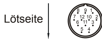
Abb. 11: Sicht auf Resolver-Gegenstecker der Serie RC (Gewinde M23)
