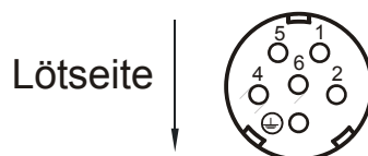
Abb. 10: Sicht auf Motorgegenstecker der Serie SC (Gewinde M23)
