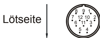
Abb. 31: Sicht auf EnDat-Gegenstecker der Serie RC (Gewinde M23)
