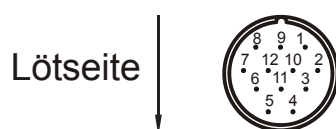
Abb. 22: Sicht auf EnDat-Gegenstecker der Serie RC (Gewinde M23)
