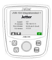
Die dargestellte Node-ID ist die im JVM-104 eingestellte Adresse des Busses CANopen® 1. Diese Adresse ist über die Tasten ▲ und ▼ einstellbar.
