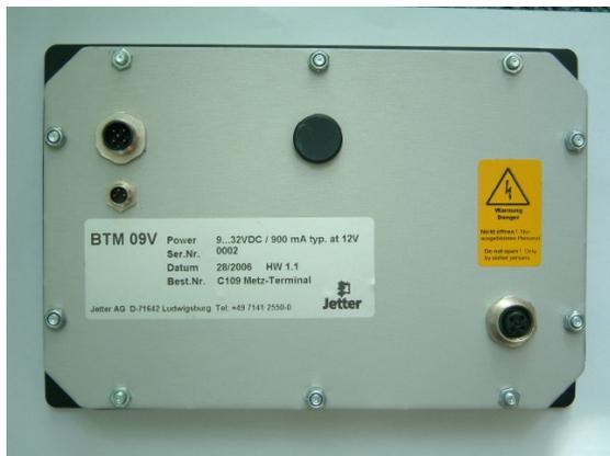
Auf der Rückseite des Gerätes befinden sich 3 wasserdichte Anschlussstecker/-buchse und das DAE (Druckausgleichelement).
