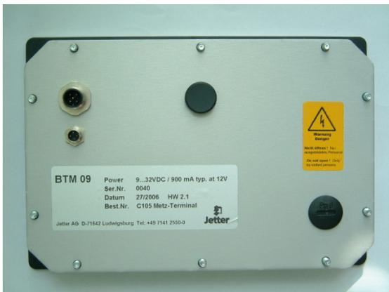
Auf der Rückseite des Gerätes befinden sich 2 wasserdichte Anschlussstecker und das DAE (Druckausgleichelement).
