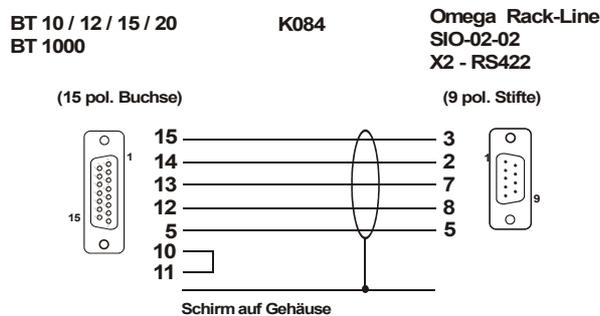
Verbindungskabel Baumüller OMEGA Rack-Line über CPU 68-002...6-02 Buchse X4:
