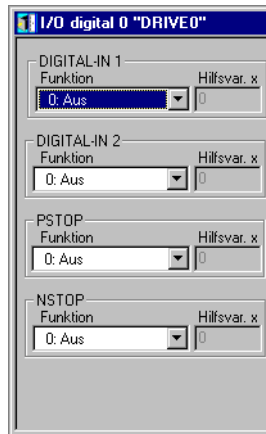
Abb. 8: Digital I/O Funktionen ausschalten per DRIVE-Software
