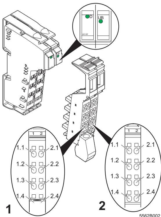
Bild 2 IB IL AO 1/SF mit zugehörigen Steckern
