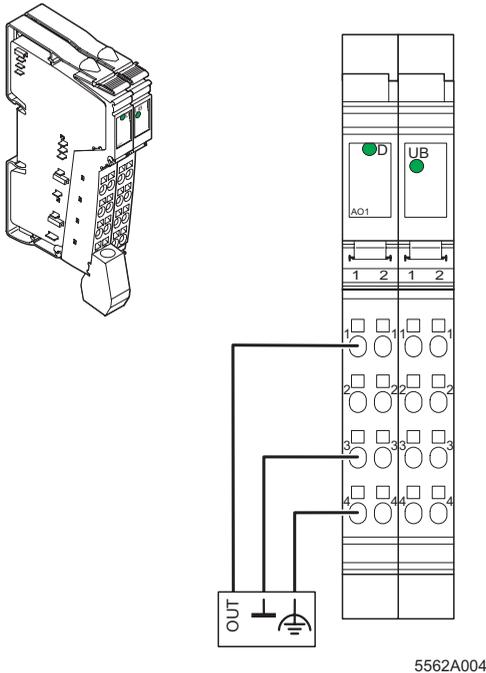
Bild 5 Aktor am Spannungsausgang
