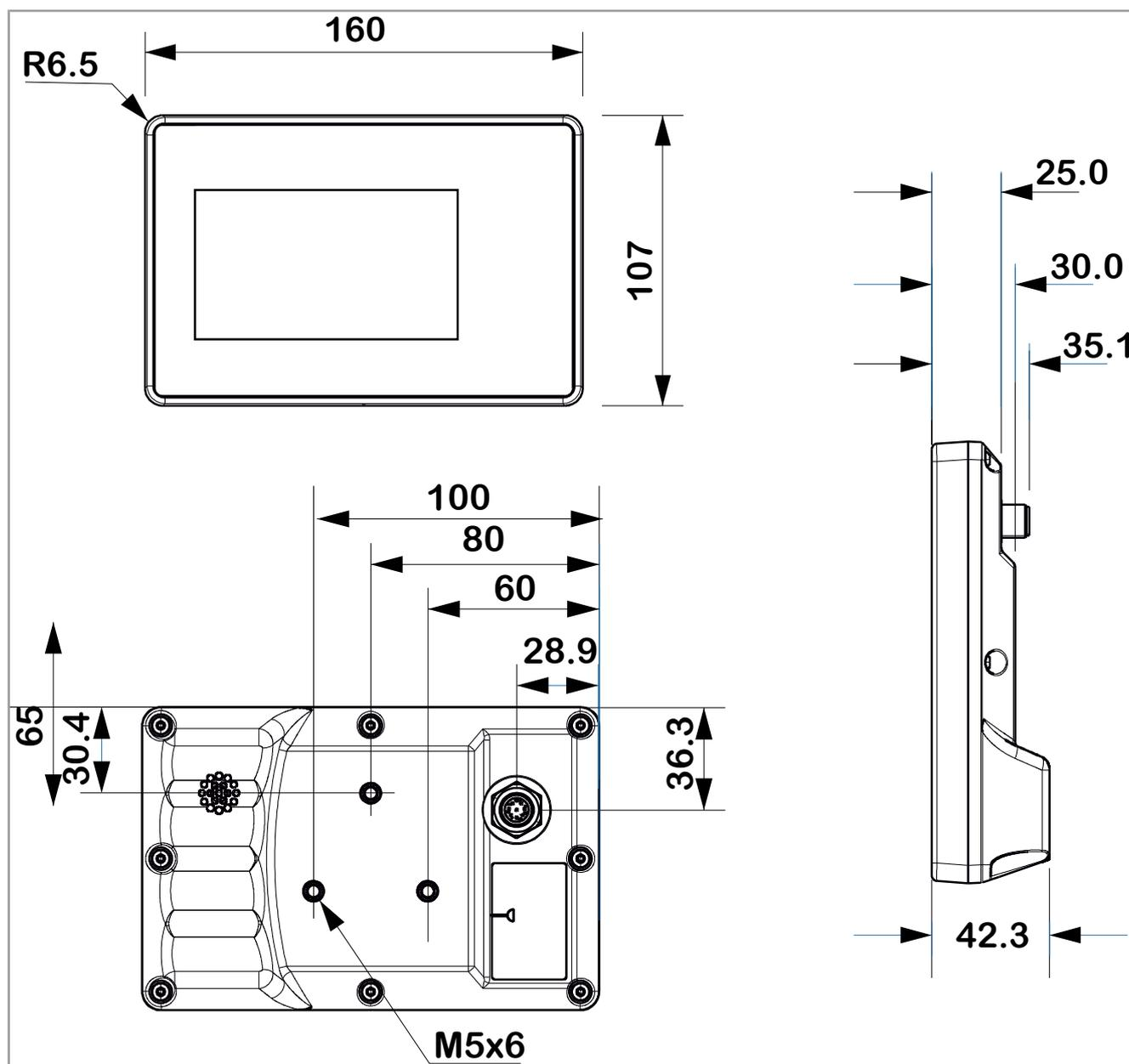
Fig. 4: Dimensions en mm
