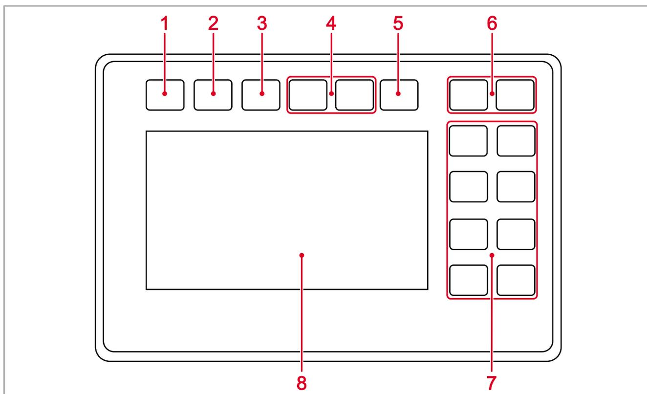
**Fig. 1:** Face avant de l'appareil de commande
