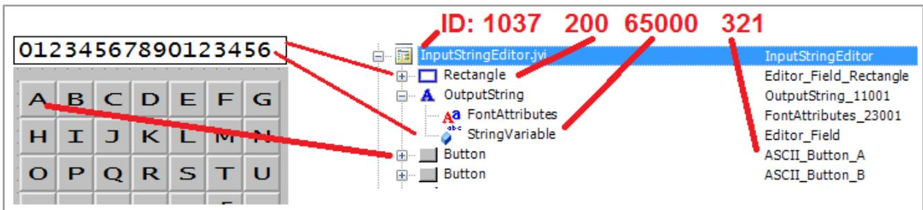
Fig. 9: Exemple de programmation pour l'éditeur de chaîne
