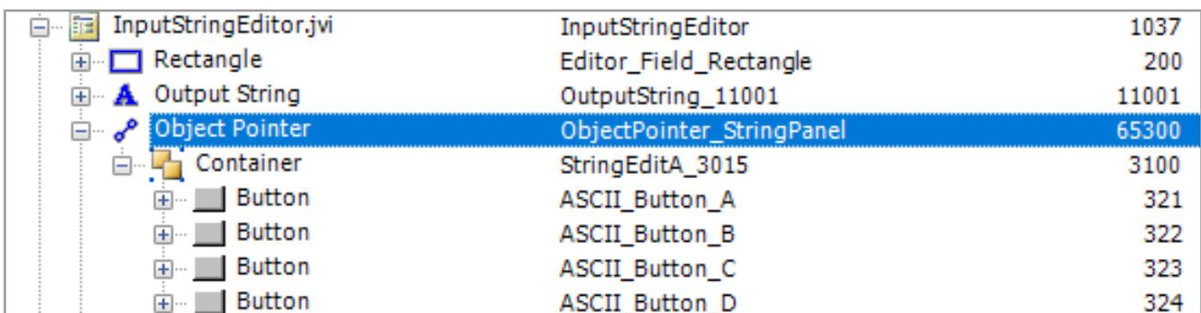
Fig. 11: Pointeur d'objet pour changer le jeu de clavier
