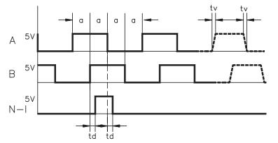
Edge spacing a  $\geq$  0,20  $\mu s$ Edge steepness tv  $\leq$  0.1  $\mu s$ Delay N-I-td  $\leq$  0.1  $\mu s$
